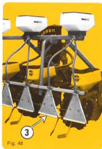
Fig. 48 : rampe herbicide généralisée Fig. 49 : rampe herbicide localisée Fig. 50 : rampe anti-limaces (guide descente) Fig. 51 : entraînement pour les 3 modèles
